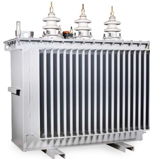
Трансформаторы силовые, трехфазные, двухобмоточные с естественным охлаждением масла. Трансформаторы этого типа выполнены в герметичном исполнении с полным заполнением маслом. Температурные изменения объема масла компенсируются изменением объема гофрированных стенок бака за счет пластичной их деформации. Преимуществом герметичных трансформаторов является то, что масло не имеет непосредственного контакта с атмосферой, исключая попадание влаги из окружающей среды.
